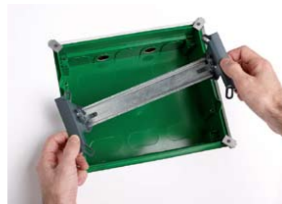
Отстраняемо шаси за монтаж в легнало положение, както и възможност за регулиране и прецизно хоризонтално и вертикално позициониране (версия за вграден монтаж)
